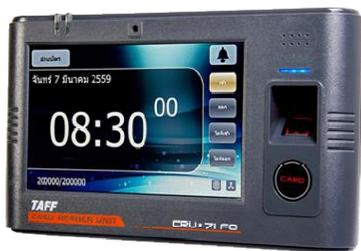
เครื่อง CRU-71 เป็นระบบบันทึกเวลาและควบคุมการเข้า-ออก ประตู หรือ อุปกรณ์ต่อพ่วงอื่น ๆ เช่น Turnstile สามารถต่อกับหัวอ่านบัตร RD-67CL ได้ 1 หัวอ่าน
